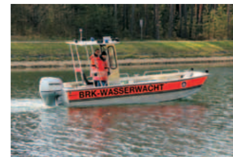
Motorrettungsboot Kat. II mit elektrohydraulischer Bugklappe
