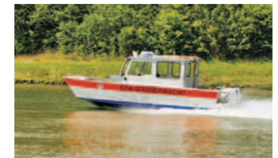
Motorrettungsboot Kat. III mit elektrohydraulischer Bugklappe und Kabine
