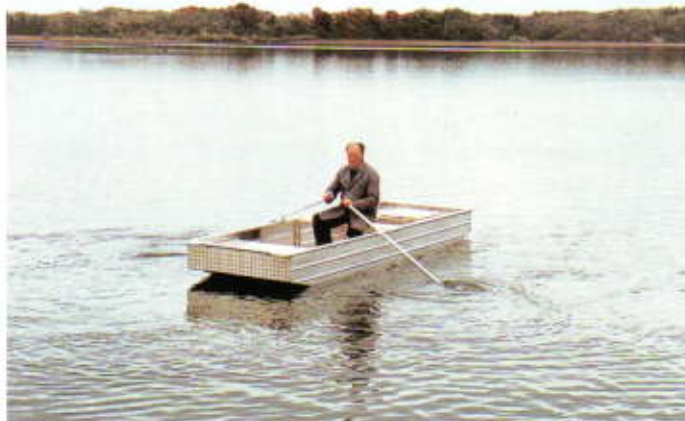
Im Sommer kann der Rumpf des Eisrettungsschlittens als solides Boot eingesetzt werden
